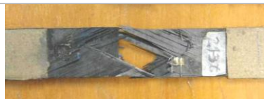
Рис. 7. Разрушение при растяжении образцов с укладкой волокон 90^\circ_2/\pm 20^\circ
