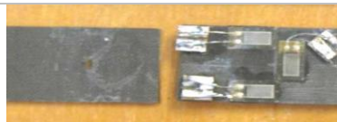
Рис. 4 а. Разрушение при растяжении образцов с поперечной укладкой волокон
