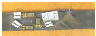
Рис. 9. Разрушение при сжатии образцов с укладкой волокон 02/\pm 70^\circ 3
