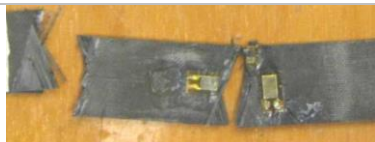
Рис. 4 б. Разрушение при растяжении образцов с укладкой волокон 0_2/\pm 70_3
